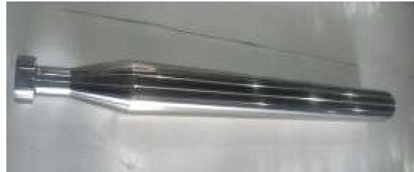
Eixo fabricado e revestido através do processo Jato Fusão com aplicação de Colmonoy
