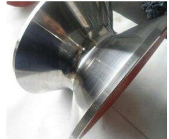
Bobinas e polias recuperadas através do processo Arc Spray com aplicação de materiais especiais
